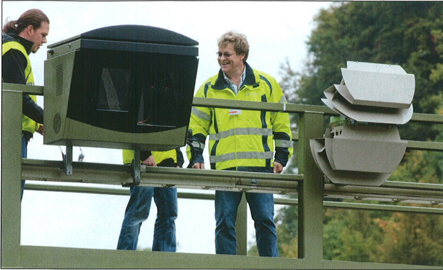
Augenschein: Die Presse durfte sich die neuen Kontrollinstrumente aus der Nähe ansehen – links der Kamerakasten, rechts der Laser.
